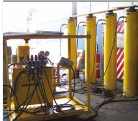
▲ Cilindri customizzati a doppio effetto per 500 t con corsa di 1,83 m per il sollevamento di pale a fune.
