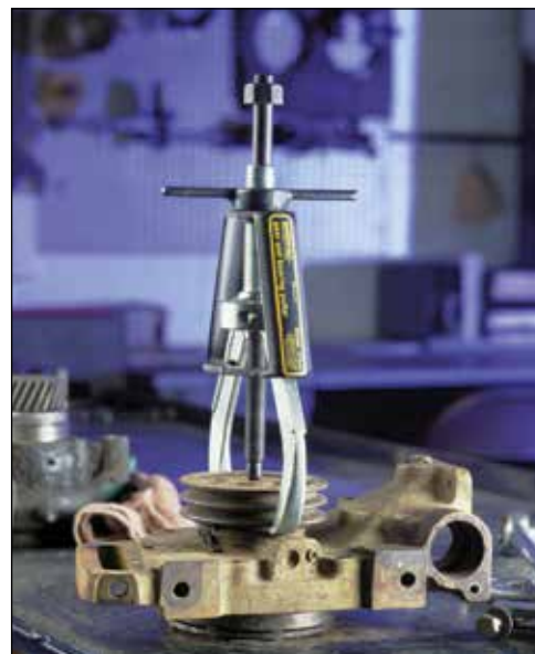
▲ Estrattore EP-204 a 2 ganasce, posizionato in modo da estrarre la puleggia di azionamento di una pompa idraulica.
