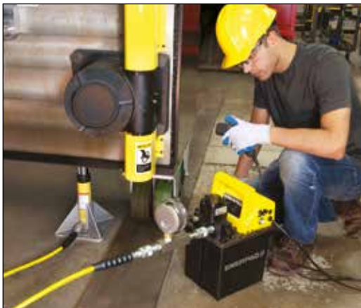
◀ La pompa sommersa con comando a distanza (serie PEJ) semplifica la manutenzione di questa macchina.
